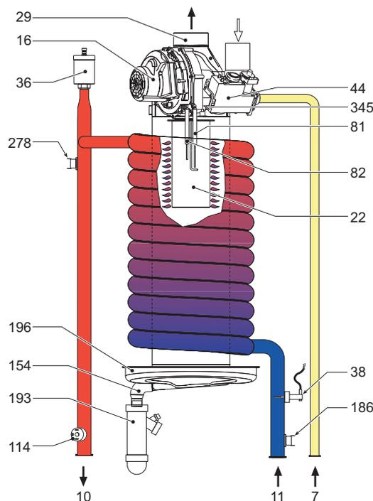
fig. 45 - Circuito idraulico
