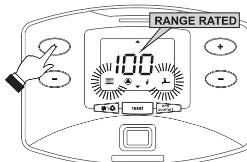
fig. 38 - Modalità TEST (potenza riscaldamento = 100%)
