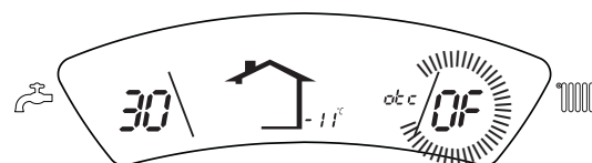
fig. 12 - Spostamento parallelo delle curve
