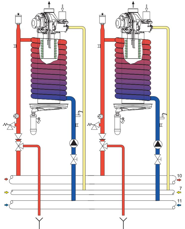
fig. 61 - Circuito idraulico modello FUTURIA POWER 160 - 250
