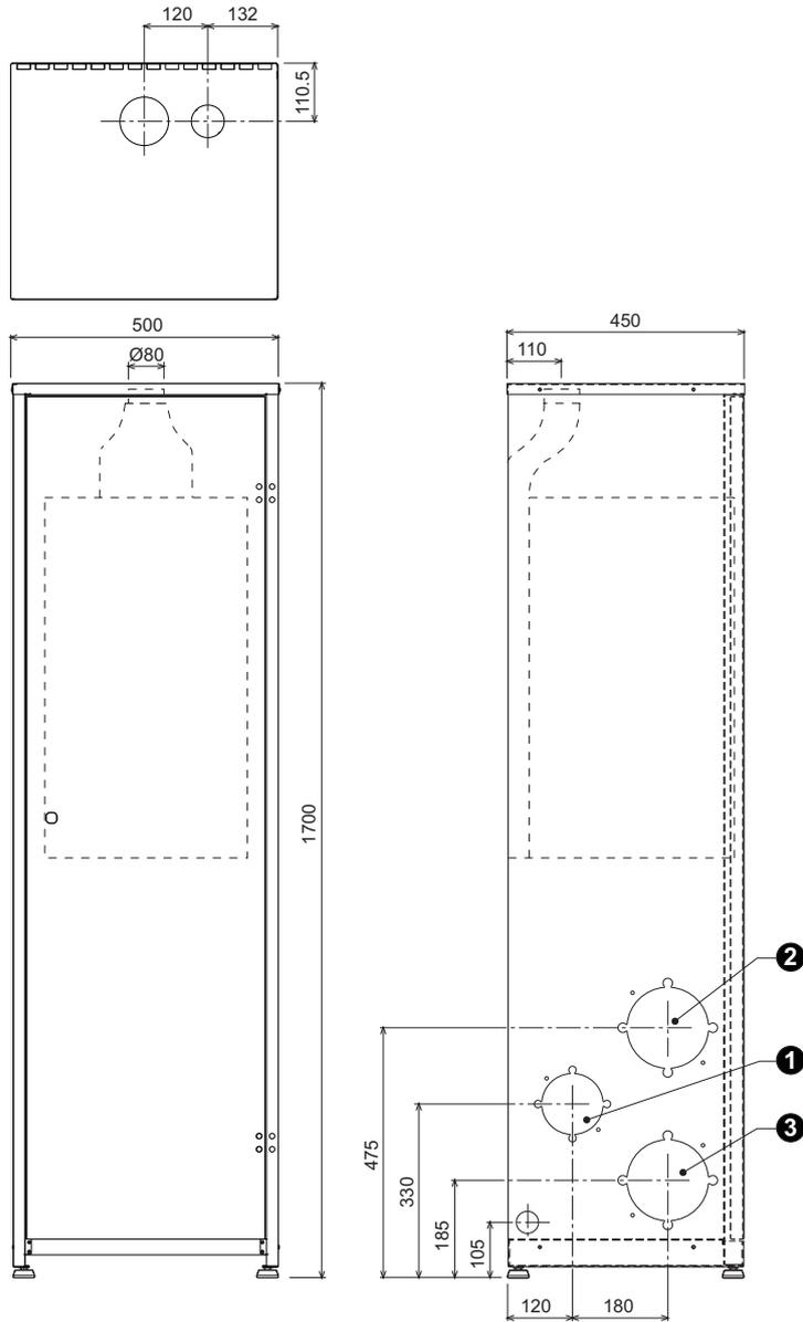
fig. 56 - Dimensioni e attacchi modello FUTURIA POWER 80 - 125
