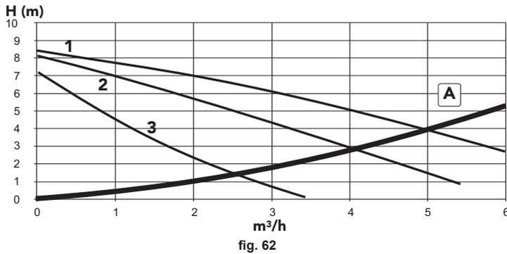
A Perdite di carico caldaia
