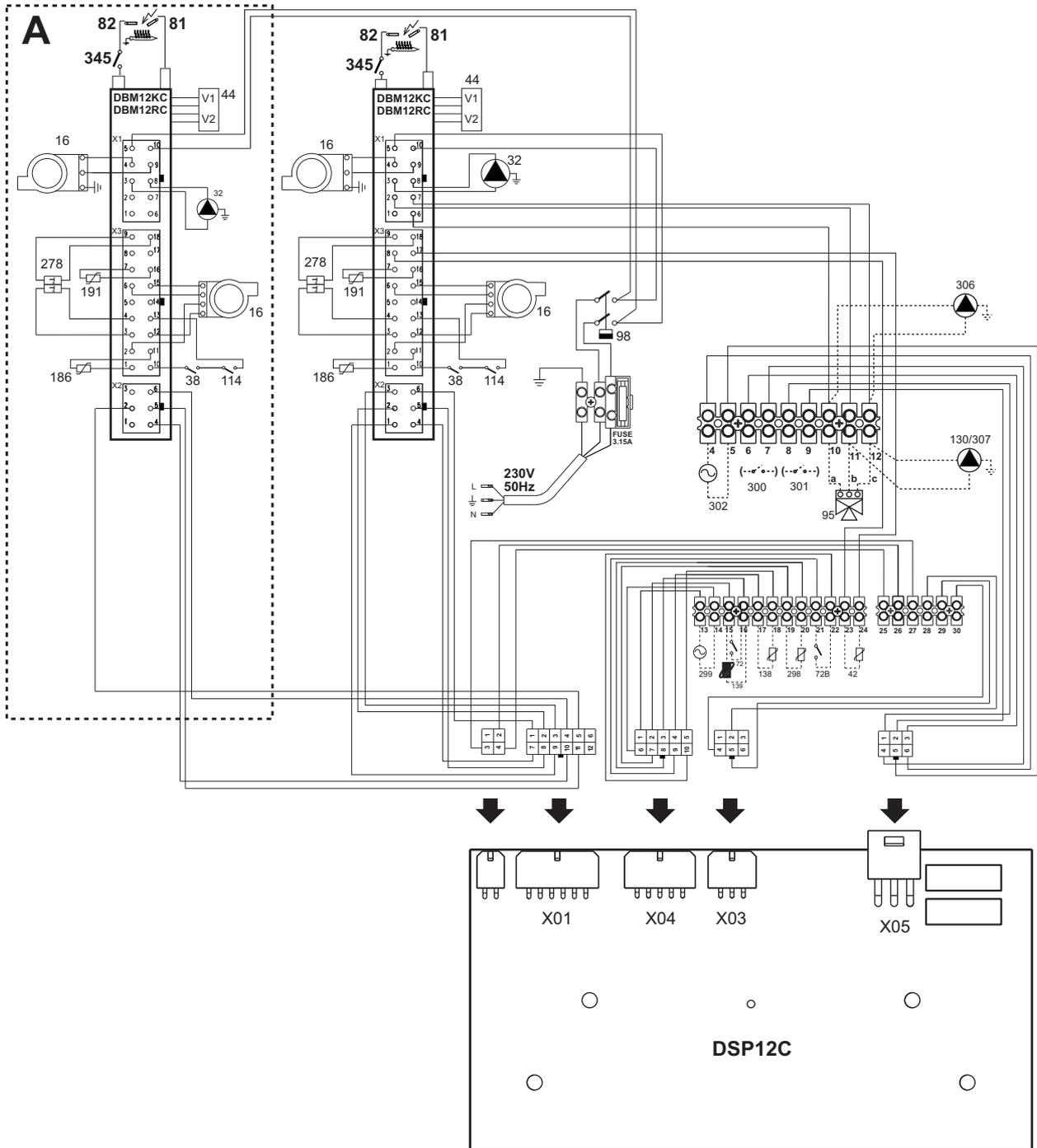
fig. 64 - Schema elettrico
