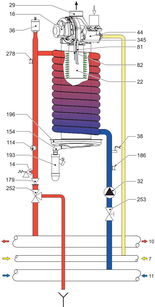
fig. 60 - Circuito idraulico modello FUTURIA POWER 80 - 125
