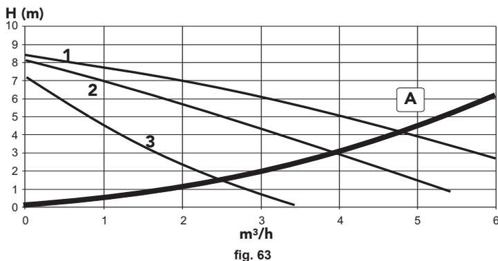
A Perdite di carico caldaia
