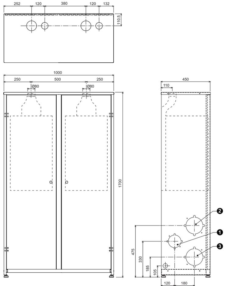
fig. 57 - Dimensione e attacchi modello FUTURIA POWER 160 - 250
