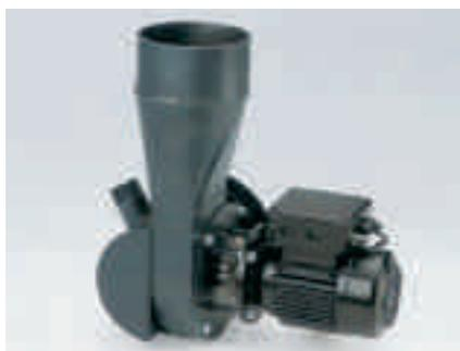
La ventola di depressione garantisce la depressione e la giusta quantità di aria comburente nella camera di combustione. Il funzionamento della ventola è regolato termostaticamente ed in relazione al fabbisogno di calore. Durante l'operazione di carico della legna la ventola è in funzione e risucchia i fumi affinché non possano invadere il locale caldaia.
