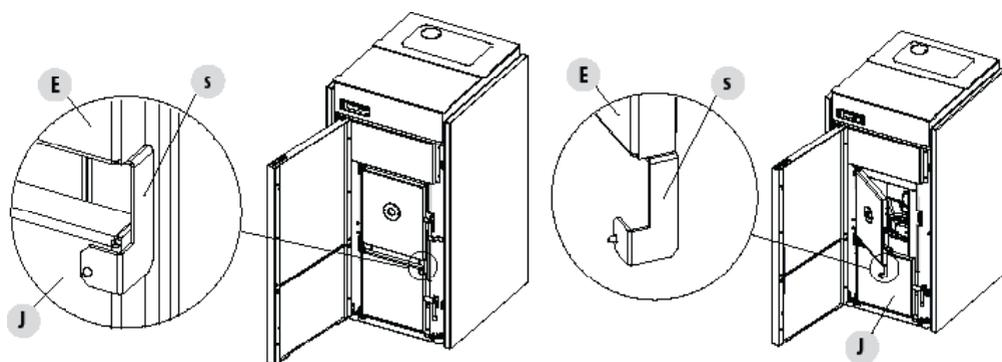
Sotto la porta del focolare "E" è fissata una staffa "s" che non permette l'apertura dello sportello inferiore "J" se la porta focolare "E" è chiusa. La porta focolare "E" è munita di un dispositivo di controllo che blocca il funzionamento della caldaia in caso resti aperta. Si attiva l'allarme A05.
