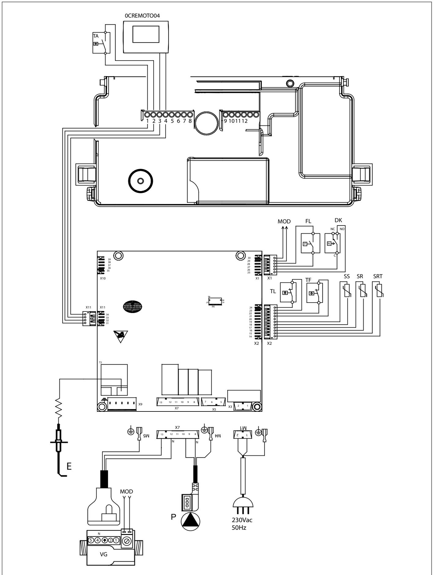
Fig. 10 Schema elettrico
