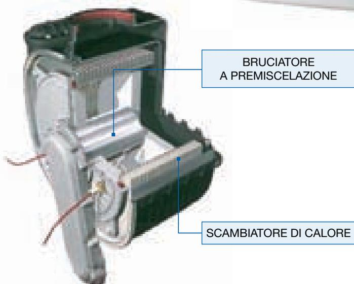
**B**asata su uno scambiatore di calore in acciaio inox ad alta superficie di scambio e ridotto contenuto di acqua e su un bruciatore a premiscelazione, questa caldaia garantisce elevate prestazioni grazie al recupero del calore contenuto nei fumi di scarico e ridotte emissioni inquinanti grazie al controllo sistematico del bilanciamento della combustione.
