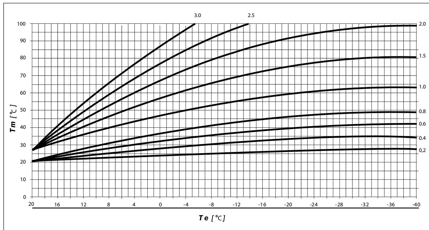
Fig. 9 Curve di termoregolazione
