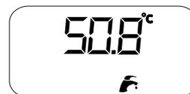
Caldaia in modalità INVERNO
