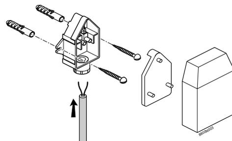
La sonda esterna si fissa al muro esterno con l'ausilio degli accessori forniti: 2 viti per legno CB  $\varnothing$  4 + tasselli.
