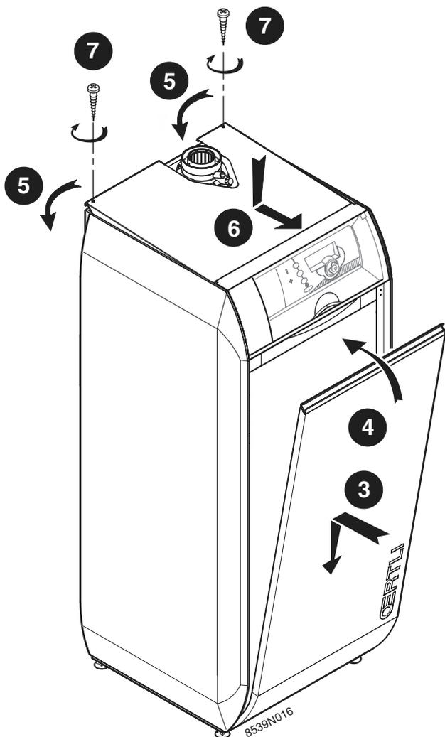
Rimontaggio dello sportello anteriore e del coperchio della caldaia: procedere invertendo la procedura di montaggio.
