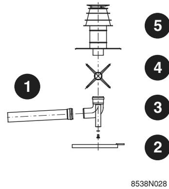
Kit di raccordo n°II - ø 80 mm - (alla caldaia)
