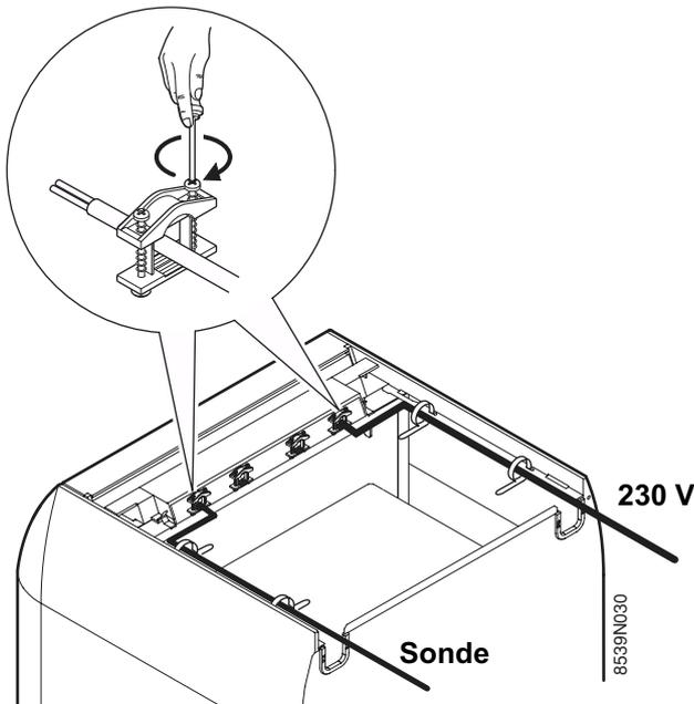
**Tutti i collegamenti si eseguono sulle apposite morsettiere, poste sul retro del pannello di comando della caldaia.**
