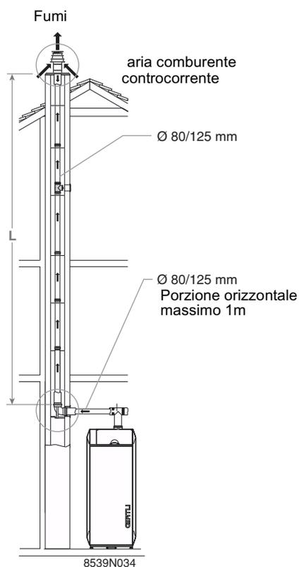
L<sub>max</sub> si misura sommando le lunghezze dei tubi aria/fumi dritti e le lunghezze equivalenti degli altri elementi.
