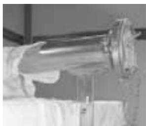
L'iniettore di carico, posizionato orizzontalmente, permette di riempire il silos in maniera completa
