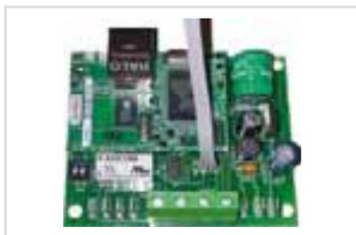
La scheda Web server consente di collegare i terminali dotati di controllo elettronico con logica PID a una normale rete LAN cablata.
