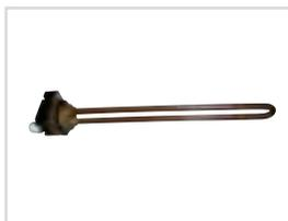
Resistenza elettrica ad 1 elemento ricurvo in acciaio inox AISI 321, su tappo filettato 1" 1/2 M gas, custodia prot. IP55 termostato unipolare a riarmo automatico 4°/40°C o 30°/90°C. Misure (L x Ø) = 300 x 8 mm
