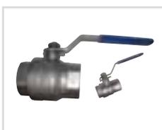
• Valvole a sfera a passaggio totale, adatte a lavorare ad alte temperature • Ideali per impianti solari • Attacchi filettati • Corpo in acciaio AISI 316 • Sistema di bloccaggio • Temperature esercizio -25°C +180°C • Ideali per i grandi impianti solari Aqua o per l'intercettazione dei campi solari (1/2").
