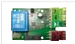
Per comandare la caldaia tramite un segnale analogico esterno 0...10 V
