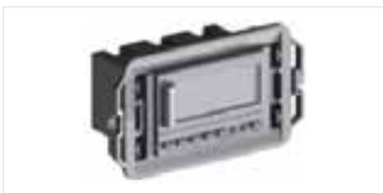
Termostato di tipo elettronico con selettore ON/OFF, selettore a tre velocità e selettore estate/inverno. Il comando può essere abbinato alle versioni S e SI, deve essere accoppiato con la scheda elettronica cod. 03-0216. Campo di regolazione temperatura da 5°C a 30°C. Alimentazione 230V. Dispone di due contatti puliti, uno estivo e uno invernale. Per maggiori informazioni consultare il THIT9203.
