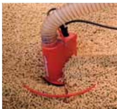
Con il sistema di aspirazione è possibile coprire distanze maggiori e una differenza di altezza rispetto al deposito in cantina o al silos in tessuto pari al massimo a 6 metri.
