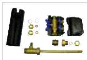
Da utilizzare in presenza di sistemi Aqua. Composto da una lancia con isolamento da collegare al bollitore, rubinetto di carico e raccorderia per il collegamento. Valore Kv lancia: 26.
