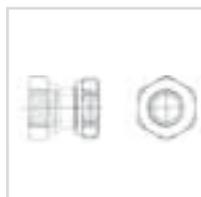
Coppia di raccordi di adattamento da 3/4": permette di adattare l'attacco del terminale o dei gruppi valvole per raccordi maschio da 3/4" con tenuta di tipo tradizionale (canapa, teflon, ecc.).
