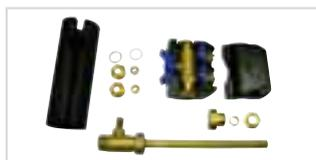
Da utilizzare in presenza di sistemi Aqua. Composto da una lancia con isolamento da collegare al bollitore, rubinetto di carico e raccorderia per il collegamento. Valore Kv lancia: 26. Per maggiori informazioni consultare il THIT9173.
