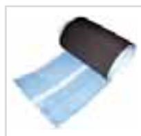
Guaina ROLL FLEX composto da una lamina di alluminio accoppiata ad uno strato di butile per sigillare ed impermeabilizzare all'acqua tutte le interruzioni della copertura in corrispondenza delle lamiere zincate preverniciate e dei coppi/tegole. Colore marrone, lunghezza 5 m.
