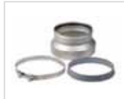
Adattatore per passare dal collegamento standard caldaia Ø250 mm a Ø200 mm. Sia per alimentazione dell'aria come collegamento dei gas di scarico. L = 145 mm.
