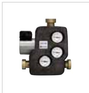
Gruppo pompa da impiegare per il circuito caldaia a legna - accumulo. Necessario per prevenire la formazione di condensa dovuta a temperature di ritorno troppo basse. Composto da pompa di circolazione e valvola miscelatrice termostatica. Dotata di valvole d'intercettazione con attacchi 1" 1/4 (per modelli fino a 35 kW) e 1" 1/2 (per modello da 60 kW). Isolamento in EPP e termometri inclusi.
