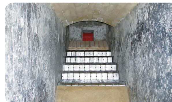
Bruciatore a griglia mobile con camera di combustione in materiale refrattario
