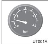
Per ripristinare questa situazione di arresto dell'apparecchio controllare la pressione sull'idrometro "D" e, se dovesse risultare inferiore a circa 0,4 bar, provvedere al reintegro dell'acqua per mezzo del rubinetto posto nella parte inferiore della caldaia fino ad ottenere la pressione di 1 bar. Se questo evento dovesse ripetersi con frequenza, chiedere l'intervento del Servizio Assistenza Tecnico autorizzato.
