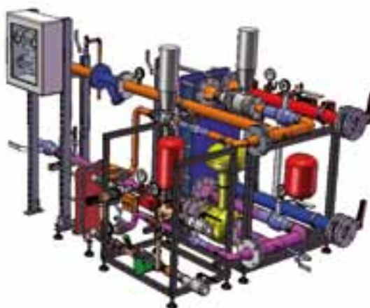
Sottostazione TLR riscaldamento + produzione A.C.S. sanitaria
