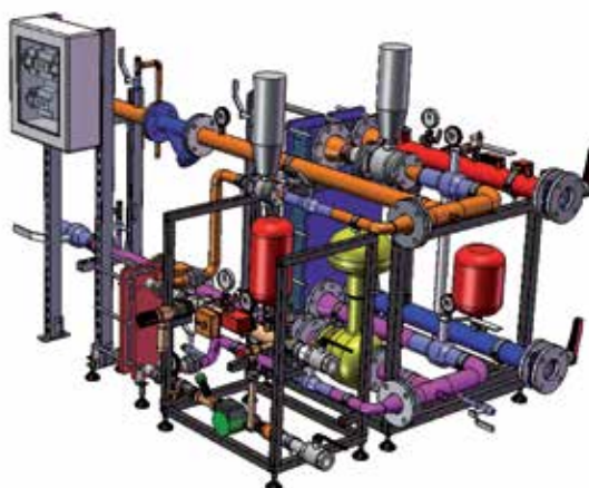
Sottostazione TLR riscaldamento + produzione A.C.S. sanitaria
