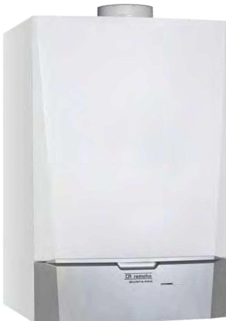
Caldaie murali a gas a condensazione a metano, con possibilità di conversione a GPL e aria propanata. Rendimento annuale fino al 109%. Emissioni molto ridotte di agenti inquinanti. Scambiatore di calore monoblocco in alluminio silicio, bruciatore gas a premiscelazione totale. Campo di modulazione potenza da 17 a 100%. Dimensioni 690x450x450 mm.
