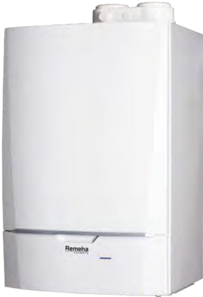
Caldaie murali a gas a condensazione a metano, con possibilità di conversione a GPL e aria propanata. Rendimento annuale fino al 109%. Emissioni molto ridotte di agenti inquinanti. Scambiatore di calore monoblocco in alluminio silicio, bruciatore gas a premiscelazione totale. Campo di modulazione potenza da 17 a 100%. Dimensioni 690x450x450 mm.
