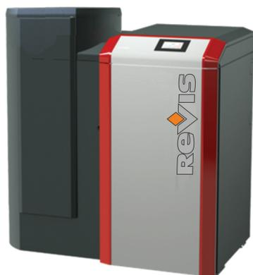
Caldaia in acciaio per riscaldamento centrale a pellets ad elevata efficienza energetica, con funzionamento automatico e regolazione elettronica. Sistema di combustione con attivazione mediante iniezione di aria ad alta temperatura, bruciatore a tazza con convogliamento proporzionale del combustibile e dell'aria comburente.
