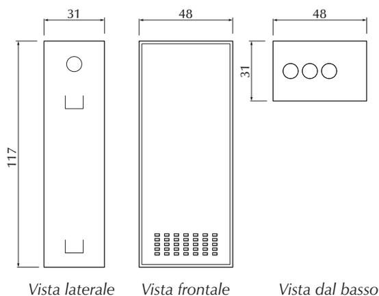
**Remeha Avanta Plus** è una caldaia murale a condensazione istantanea con ampio grado di modulazione della potenza, fino ad un minimo di 6,2 KW.
