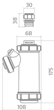
Raccordo a T Ø 60 mm con chiusura per scarico condensa
