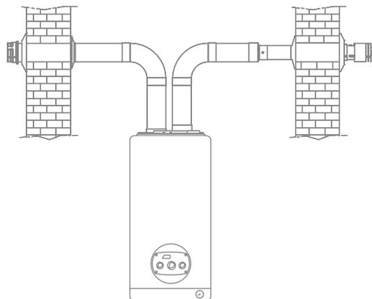
Accessori in polipropilene per intubamento Ø 80 mm (misure espresse in mm)
