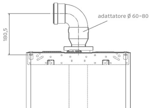
Condotto concentrico per scarico fumi/aspirazione aria
