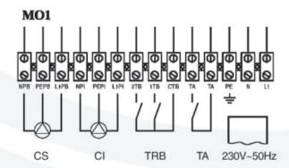
N.B: Quando si collega il termostato ambiente è necessario scollegare ed eliminare il ponte interno al connettore.
