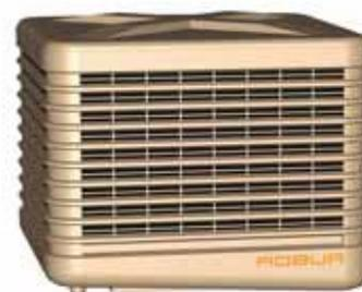
AD 14 utilizza uno speciale pacco evaporativo mantenuto bagnato da un flusso d'acqua, contenuta nel serbatoio interno ed inviata ai pacchi evaporativi per mezzo di una pompa di circolazione (fig. 1).
