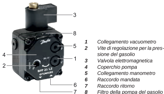
Figura 7-4 Pompa del gasolio
