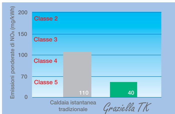
Graziella TK è un gruppo termico a condensazione a basamento a camera stagna ed accensione elettronica completo di accumulo di Acqua Calda Sanitaria.
