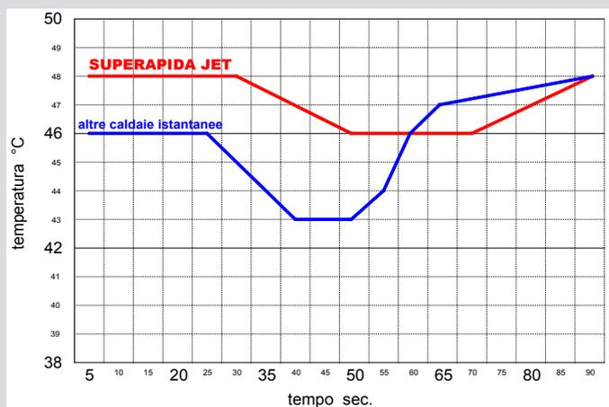
Il grafico di SUPERAPIDA JET fa notare come, nel caso di chiusura e riapertura del rubinetto dell'acqua calda, lo sbalzo di temperatura sia minimo a garanzia di un maggior comfort di utilizzo
