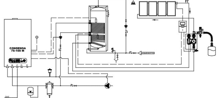
schema con separatore idraulico per riscaldamento e sanitario
