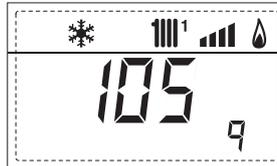
10. Visualizzazione ore di funzionamento del bruciatore in h x 100 (es. 14.000 e 10)
