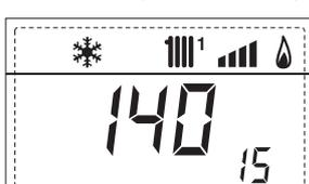
16. Contatore accessi parametri OEM (es. 48 accessi)
