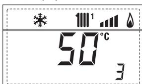
4. Visualizzazione temperatura sonda ausiliaria c
