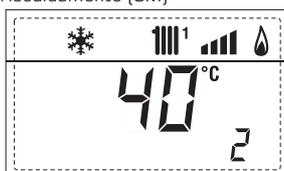
3. Visualizzazione temperatura sonda sanitario (SS)
