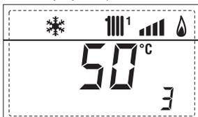
4. Visualizzazione temperatura sonda ausiliaria o sonda bollitore (SB)
