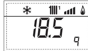
10. Visualizzazione ore di funzionamento del bruciatore in h x 100 (es. 14.000 e 10)
