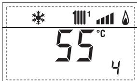
5. Visualizzazione temperatura sonda fumi
