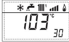
29. Visualizzazione valore temperatura sonda solare S2 con schedino solare INSOL
