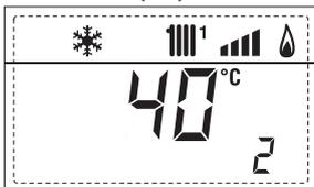
3. Visualizzazione temperatura sonda sanitario (SS):
