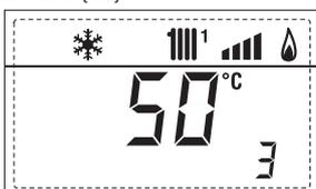
4. Visualizzazione temperatura sonda ausiliaria
