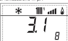
9. Visualizzazione numero giri ventilatore in rpm x 100 (es. 4.800 e 1.850 rpm)
