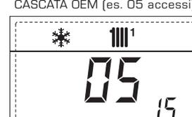
17. Visualizzazione portata sanitaria flussimetro (es. 18 l/min e 0,3 l/min) o stato flussostato (rispettivamente ON e OFF)
