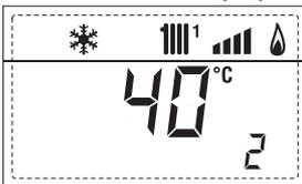
3. Visualizzazione temperatura sonda sanitario (SS) solo per caldaie istantanee
