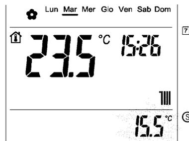
[+] e [-]: incremento/decremento (+/- 0.5°C) temperatura riscaldamento
