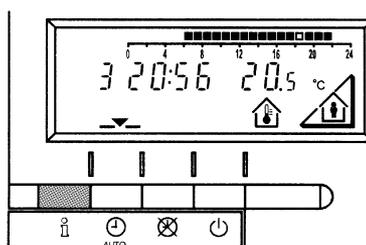
Ad ogni azionamento del tasto Info vengono visualizzati uno di seguito all'altro i valori sotto elencati. La termosonda continua a funzionare in modo indipendente dalla visualizzazione
