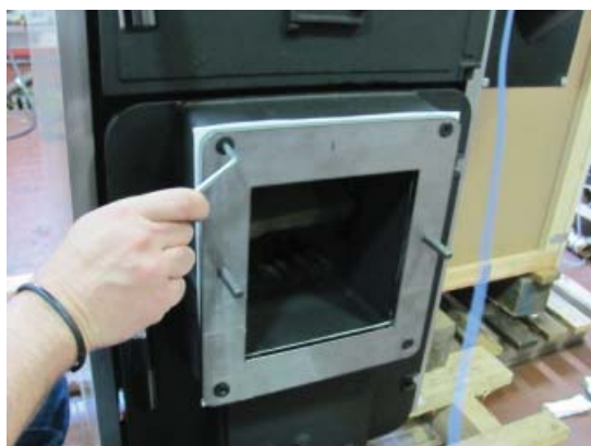
Fig. 23 Flangia fissata alla porta della camera di combustione
