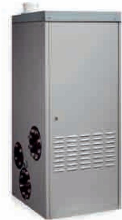
Caldaia a condensazione a basamento per centrale termica a modulazione continua ad alto rendimento Cl. 4 Stelle a basse emissioni di NOx classe 5. Generatore di calore per solo riscaldamento, è omologato per l'installazione all'interno e all'esterno (protezione IP X5D) ed è omologato dall'INAIL per l'installazione in batteria con unico tronchetto. L'allestimento comprende il circolatore modulante ad alta efficienza.
