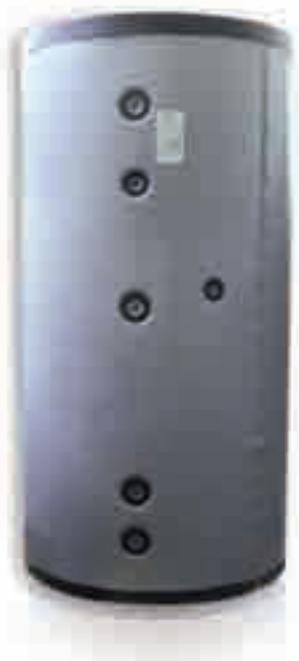
Serbatoi in acciaio al carbonio del tipo tank-in-tank dotati di singolo scambiatore fisso, con un secondo serbatoio interno in acciaio al carbonio vetrificato secondo normativa DIN 4753. I bollitori DODO/DX sono isolati esternamente tramite applicazione di un mantello in poliuretano morbido sp. 100 mm. Questa tipologia di bollitore viene impiegata per la produzione di acqua calda sanitaria e di riscaldamento.
