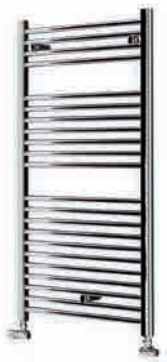
Radiatore da bagno in acciaio con collettori laterali a D 30×40 mm e tubi tondi orizzontali da 22 mm saldobrasati. PIAVE viene fornito anche in versione solo elettrico.
