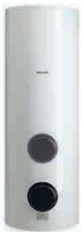
Bollitore in acciaio al carbonio vetrificato secondo normativa DIN 4753 dotato di doppio scambiatore fisso. L'isolante esterno è costituito da calotte in PU rigido amovibili e finitura con ABS colore grigio RAL 9006.
