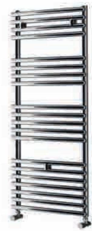
Radiatore da bagno in acciaio con collettori laterali tondi di 35 mm e tubi orizzontali da 22 mm saldati a proiezione. ARNO viene fornito anche in versione solo elettrico.
