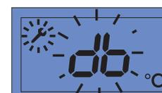
**Sensore riscaldamento (priorità 13)**Descrizione: *Avaria al sensore riscaldamento*
