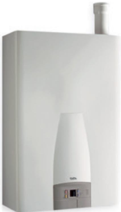
Caldaia a condensazione per centrale termica a modulazione continua ad alto rendimento Cl. 4 Stelle a basse emissioni di NOx classe 5. Generatore omologato dall'INAIL per l'installazione in batteria con unico tronchetto. L'allestimento comprende il circolatore modulante ad alta efficienza. Omologazione scarico fumi B23-C13-C33-C43-C53-C63-C83.
