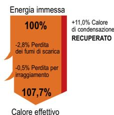
Confronto energetico fra caldaia convenzionale ad alto rendimento e caldaia a condensazione con temperatura dell'acqua di riscaldamento a 40°/30°C.
