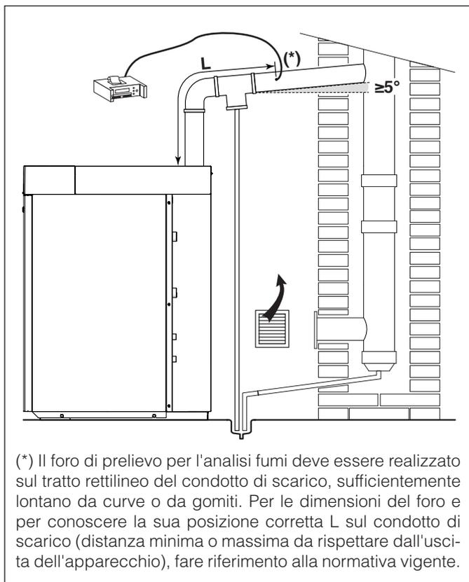
(\*) Il foro di prelievo per l'analisi fumi deve essere realizzato sul tratto rettilineo del condotto di scarico, sufficientemente lontano da curve o da gomiti. Per le dimensioni del foro e per conoscere la sua posizione corretta L sul condotto di scarico (distanza minima o massima da rispettare dall'uscita dell'apparecchio), fare riferimento alla normativa vigente.
