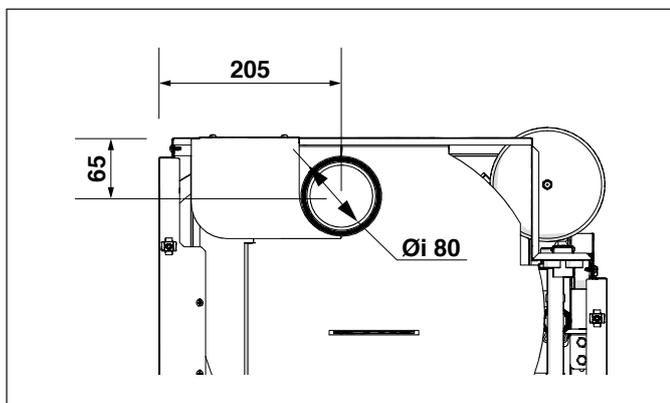
Il gruppo termico **ACQUAHOME 25 B BLU** aspira l'aria comburente dal locale di installazione attraverso le aperture di aerazione che devono essere realizzate in conformità alle Norme Tecniche.
