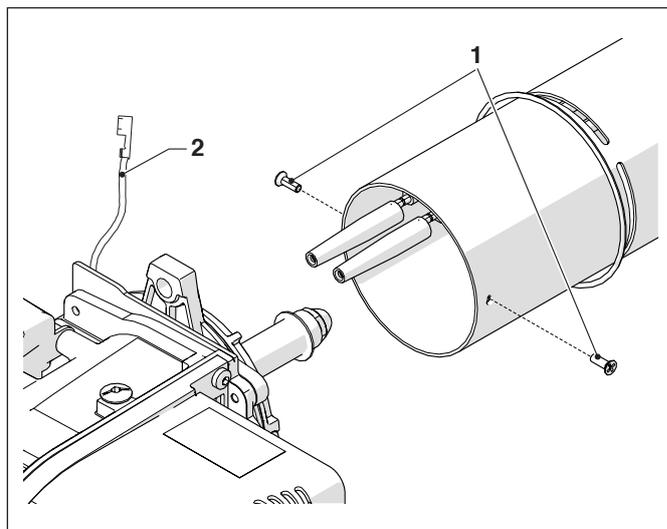
**!** Con il bocaglio smontato verificare il bordo anteriore dello stesso che deve essere con profilo regolare esente da incrostazioni, bruciature o deformazioni.
