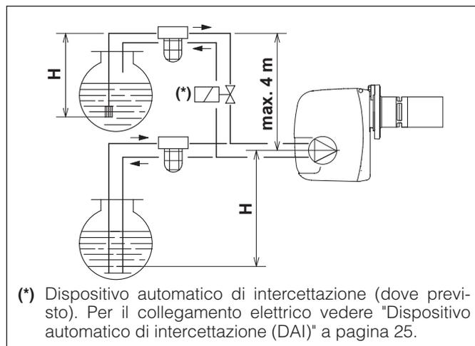
⚠ Qualora sia prevista l'installazione di un'elettrovalvola di consenso nel circuito di alimentazione gasolio al bruciatore, prevedere esclusivamente impianti di tipo monotubo. Un'eventuale collegamento bitubo può compromettere il corretto funzionamento del bruciatore.
