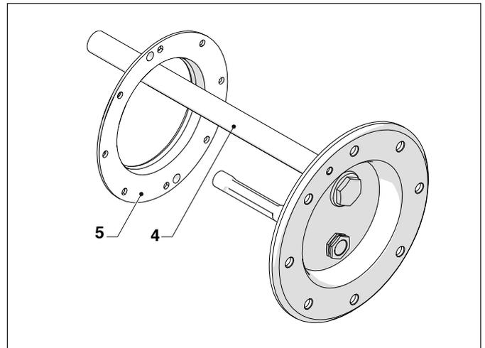
Dopo aver effettuato la manutenzione e la pulizia, rimontare tutti i componenti operando in maniera inversa a quella descritta e verificare la tenuta delle giunzioni.
