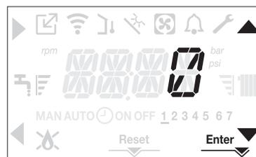
Tutte le volte che la caldaia è alimentata viene eseguito un ciclo di sfiato della durata di 6 min. Il display visualizza -AIR e si accende l'icona RESET.
