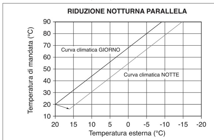
L'utente può indirettamente intervenire sul valore di setpoint RISCALDAMENTO andando ancora una volta ad introdurre, sul valore di temperatura di riferimento GIORNO (20°C) piuttosto che NOTTE (16°C), un offset che può variare all'interno del range [-5 ÷ +5].
