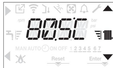
Tenendo premuto a lungo uno dei due C oppure D, il contatore aumenterà la velocità di avanzamento modificando il valore impostato. Se nessun tasto viene premuto per 5sec, il valore impostato è assunto come nuovo setpoint riscaldamento e la visualizzazione torna alla schermata principale.
