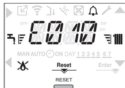
Se i tentativi di sblocco non dovessero riattivare la caldaia, interpellare il Servizio Tecnico di Assistenza di zona.
