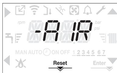
Per interrompere il ciclo di sfiato premere il tasto RESET. Portare la caldaia in stato OFF premendo il tasto ⏻.
