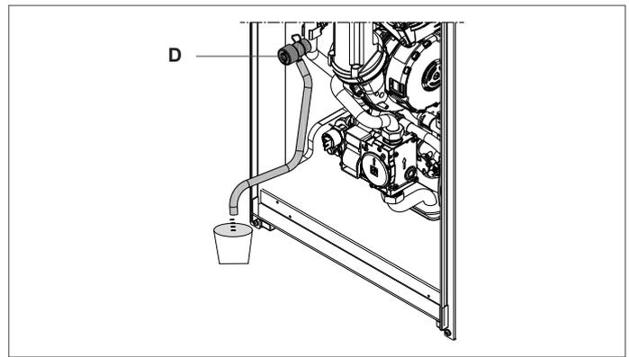
NOTA: se la pressione di rete è inferiore a 1 bar, mantenere aperto il rubinetto di riempimento (esterno alla caldaia) durante il ciclo di sfianto e chiuderlo una volta terminato.
