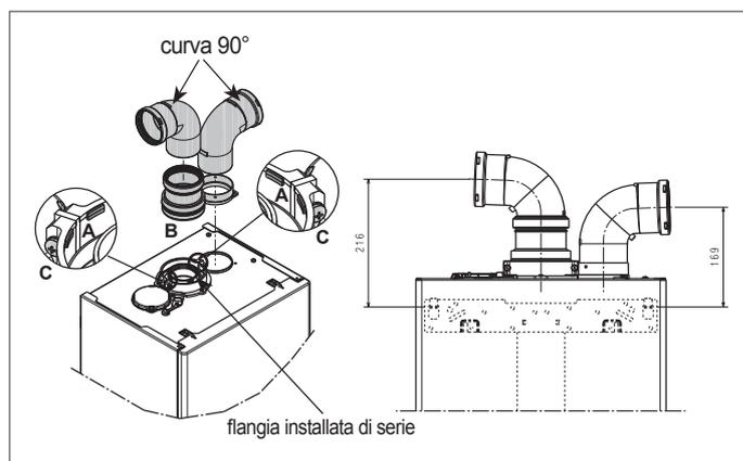
In caso si utilizzi il kit sdoppiatore da  $\varnothing 60-100$  a  $\varnothing 80-80$  al posto del sistema sdoppiato, si determina una perdita nelle lunghezze massime come indicato in tabella.
