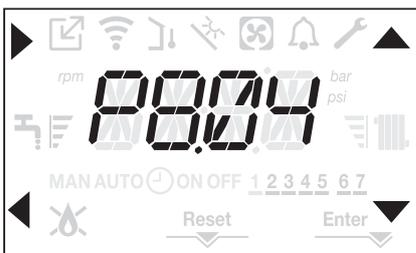
L'accesso alla programmazione parametri del menu TECNICO è protetta da password; premendo una seconda volta il tasto MENU per almeno 2sec, si visualizza la scritta PWD lampeggiante con frequenza 0,5sec ON e 0,5sec OFF per una durata di 2sec.
