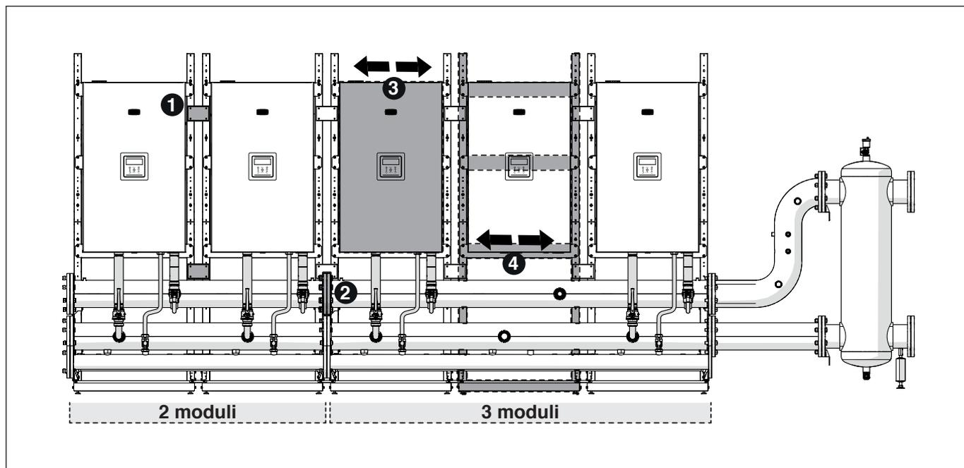
Per una corretta installazione è necessario tenere in considerazione una serie di tolleranze sulle quote di montaggio previste in fase di progettazione.
