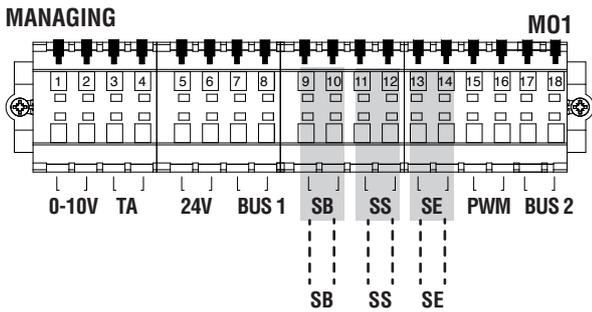
**SS** Sonda del primario
