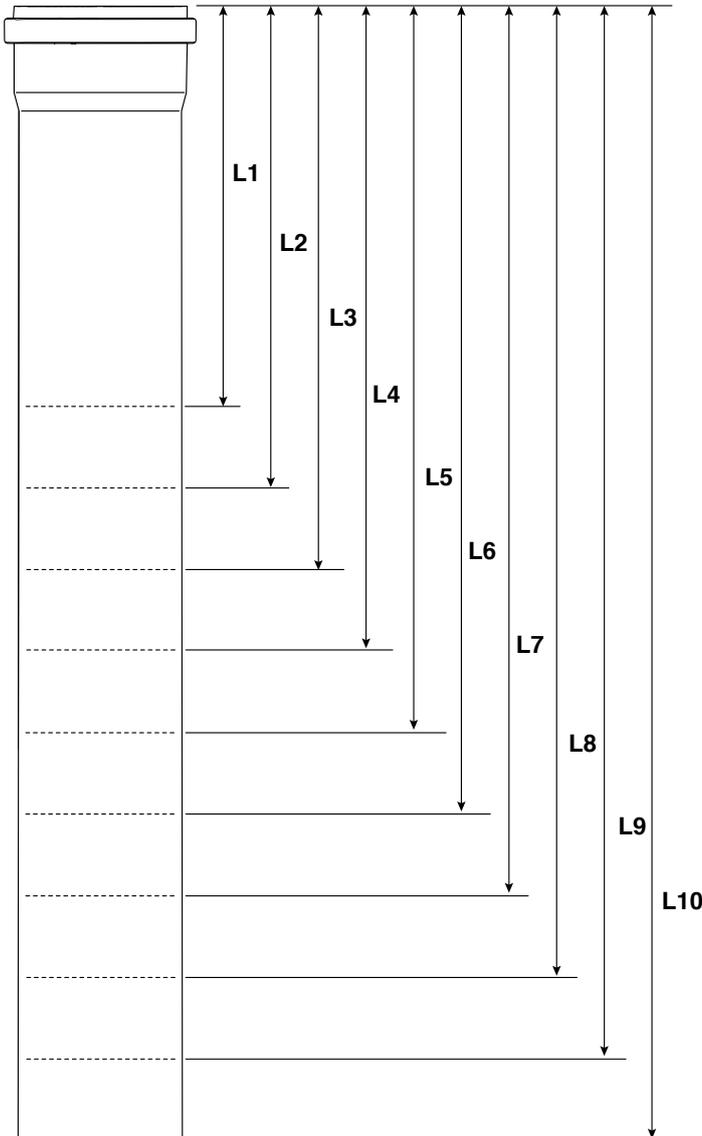
SOLO PER MODELLI COROLLA 65 P SA e COROLLA 80 P SA aventi uscita fumi DN80 è richiesto un adattatore DN80/DN110 da installare sull'uscita del tubo fumi; ciò comporta che in questo caso le lunghezze di taglio devono essere ridotte di 60mm.
