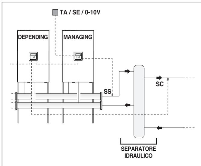
Per semplicità identifichiamo come secondario la circuitazione idraulica a valle del separatore.
