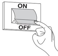
Se tutte le condizioni sono soddisfatte, alimentare elettricamente il modulo termico posizionando l'interruttore generale dell'impianto e quello principale dell'apparecchio su "accesso" ed eseguire l'analisi dei prodotti della combustione (vedi paragrafo "Regolazioni").
