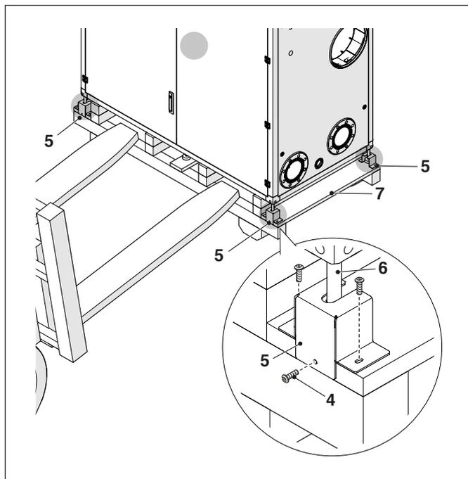
Una volta posizionato il modulo, livellarlo utilizzando le apposite regolazioni dei piedini con una chiave da 14, come indicato in figura.
