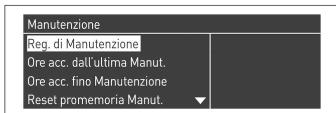
Nel menu "Impostazioni" → "Imp. caldaia" → "Manutenzione" sono riportati i comandi avanzati di questa funzione che però sono disponibili solo se si accede con la password costruttore. Se necessario agire a questo livello di accesso, contattare il Centro Assistenza Tecnica.
