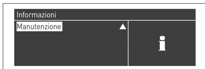
Nel menu sono anche riportate le ore trascorse dall'ultimo intervento effettuato e l'accesso ad un registro in cui sono riportate le date delle ultime 15 manutenzioni effettuate.
