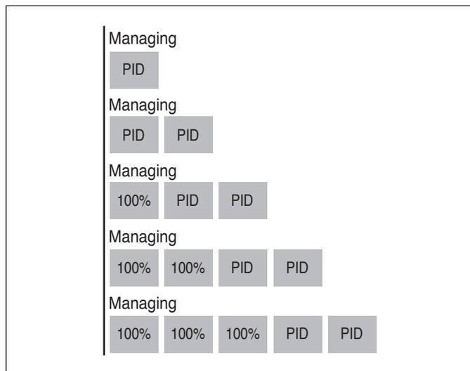
In pratica se il numero di moduli termici accesi è superiore a due, solo due moduli termici sono controllati tramite PID, mentre gli altri ricevono un segnale di portarsi alla massima potenza.
