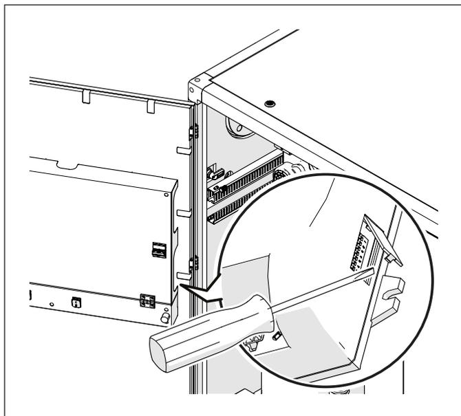
**!** I dip-switch devono essere configurati in sequenza. Il modulo termico 1 sarà sempre corretto in quanto la configurazione non è stata modificata. Dal modulo termico 2 in poi, dopo aver modificato la configurazione (da "MANAGING" a "DEPENDING"), bisognerà mantenere gli elementi in successione.
