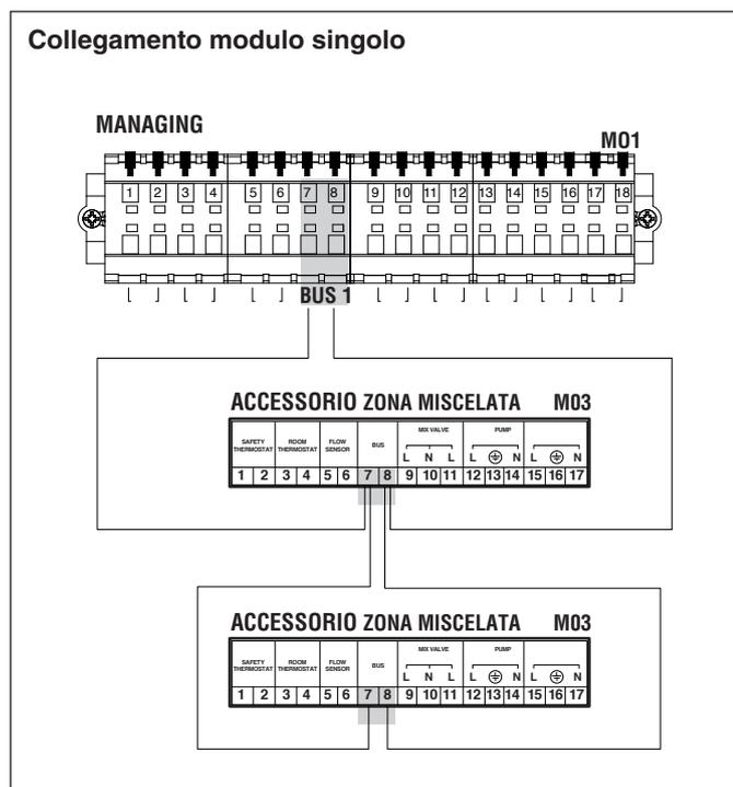
Il controllo elettronico del modulo termico verificherà automaticamente quali zone sono collegate sul bus.
