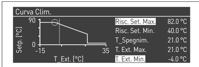
Il parametro “Comp. T. @ T.ext. Max”, se diverso da 0, trasforma la curva climatica da lineare a quadratica consentendo di adattare meglio la variazione del setpoint alla variazione della temperatura esterna.
