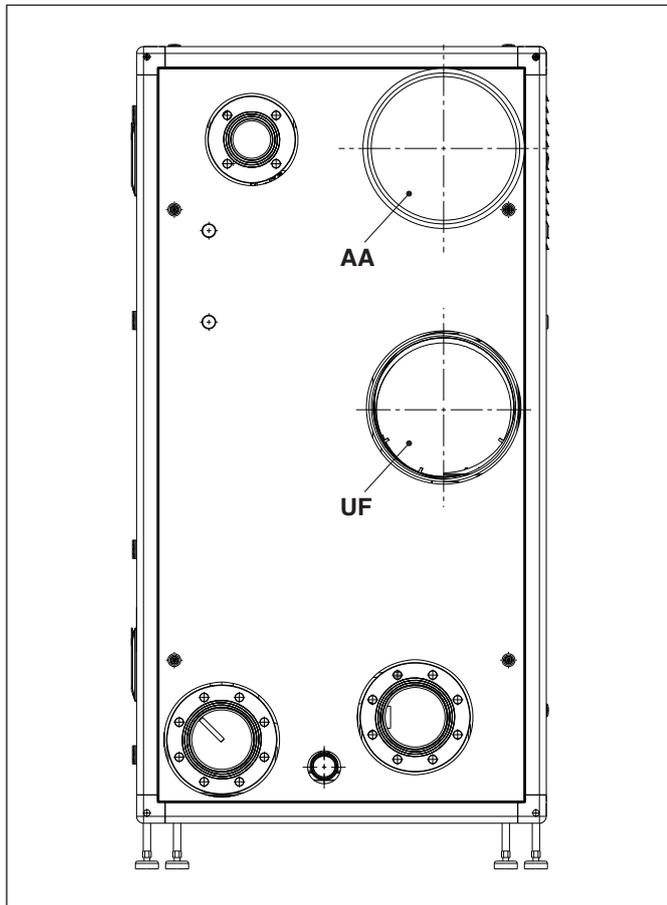
L'uscita AA esce di fabbrica tappata in configurazione B23.
