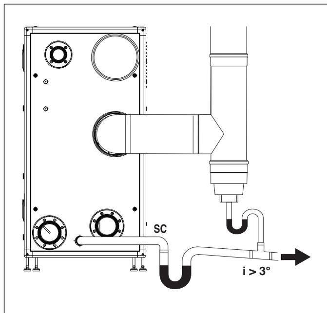
Per i cambi di direzione utilizzare un raccordo a T con tappo di ispezione il quale permette una facile pulizia periodica delle tubature. Accertarsi sempre che dopo la pulizia i tappi di ispezione vengano richiusi ermeticamente con la relativa guarnizione integra.
