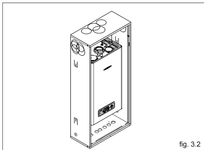
In questa tipologia di installazione, la caldaia può funzionare in un campo di temperatura da 0 °C a 60 °C.
