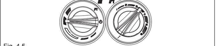
lato dalla scheda elettronica, è possibile agire sul selettore temperatura acqua riscaldamento: in senso orario il valore di correzione della temperatura aumenta, in senso antiorario diminuisce. La possibilità di correzione è compresa tra - 5 e + 5 livelli di confort che vengono visualizzati sul visualizzatore digit con la rotazione della manopola.
