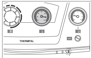
**⚠** L'intervention du thermostat de sécurité est indiquée par l'allumage du signal sur le panneau de commande ( $T > 100^\circ\text{C}$ ).
