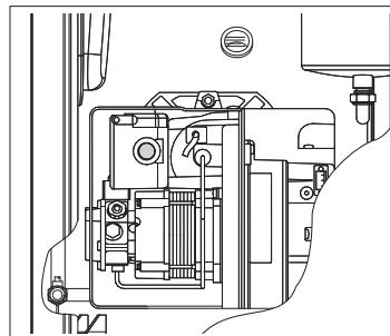
**⚠** L'intervento del termostato di sicurezza è indicato dall'accensione della segnalazione sul pannello di comando ( $T > 100^\circ\text{C}$ ).
