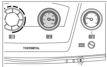
**⚠️** O accionamento do termostato de segurança é indicado no painel de comando ( $T > 100^{\circ}\text{C}$ ).
