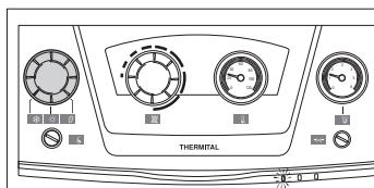
Si se verifica alguna anomalía en el encendido o en el funcionamiento, el grupo térmico realiza una PARADA CON BLOQUEO (se enciende la luz roja del panel de mandos).
