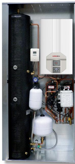
SOLARMEC ISO è il sistema a incasso THERMOMECC per il riscaldamento e la produzione di acqua calda sanitaria che prevede la caldaia premiscelata MHPY, un bollitore solare per l'integrazione alla produzione di acqua calda sanitaria e la possibilità di gestione fino a tre zone di impianto di riscaldamento. Caldaia, gestione solare e gestione zone vengono fornite per essere installate in loco all'interno del box ad incasso.
