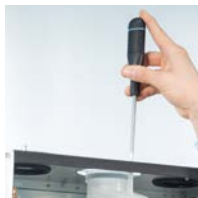
Rimozione vite blocco collettore fumi
