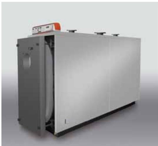
*Caldia a condensazione, fasciame in acciaio al carbonio ad altissima resistenza secondo Euronorm 25, 28. Pressurizzata ad inversione di fiamma con focolare cieco, ad alto contenuto d'acqua.*
