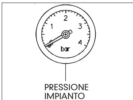
Visualizza la pressione dell'acqua all'interno del circuito di riscaldamento; il valore di tale pressione non deve essere inferiore a 0,8/1 bar (a freddo).
