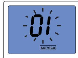
Premere il tasto (C+) per entrare nel parametro, il valore del parametro lampeggia. Correggere il valore con i tasti (C+ o C-)
