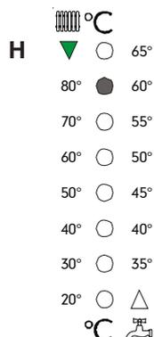
La temperatura di erogazione dell'acqua calda sanitaria sulla scala destra, (led I verde acceso)
